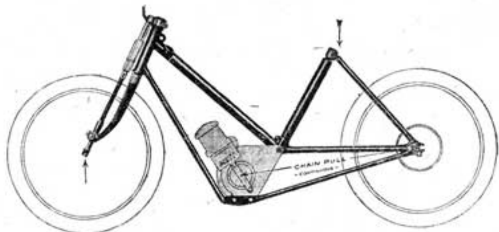
Le principe du cadre Scott. Remarquer le moteur qui l'entretoise, formant la base commune de deux triangles.
